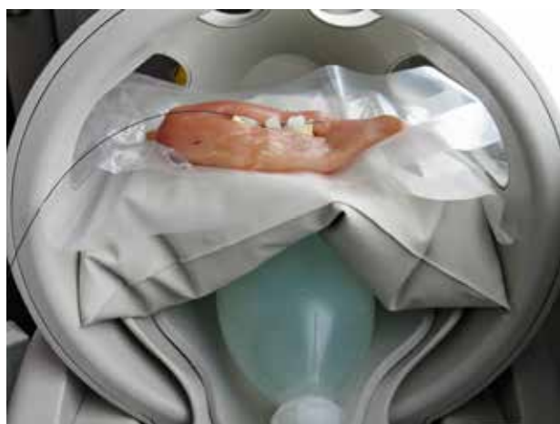
Fig. 1. I et kyllingebryst anbragt i MR-scannerens hovedspole er tandmaterialet placeret på en human fingerknogle og varmesensoren tilhæftet.
